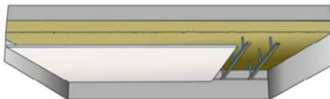
Figure 8 : Plafond suspendu constitué de fourrures et de dispositifs de suspension au support (Avec lame d'air devant l'isolant)
