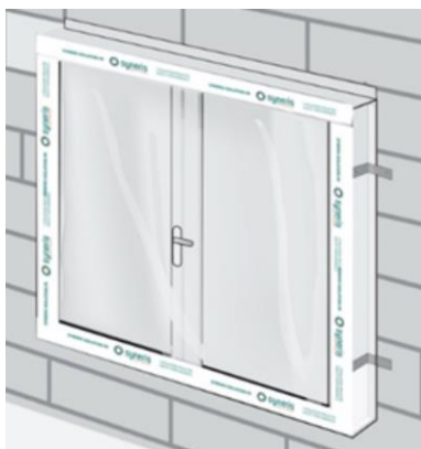
Figure 1 : Protection des éléments de construction
