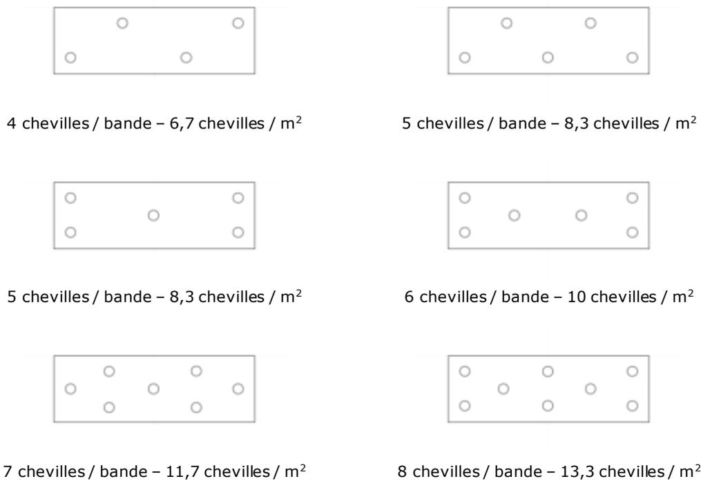
**Figure 5b : Plans de chevillage des bandes filantes de hauteur  $h$  telle que  $400 \text{ mm} < h \leq 500 \text{ mm}$  (le nombre de chevilles par m<sup>2</sup> est donné pour  $h = 500 \text{ mm}$ )**
