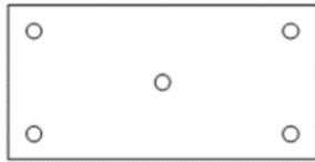
Figure 1b : Plans de chevillage - panneaux de dimensions 1200 × 600 mm
