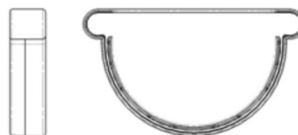
Figure 8 - Fond de gouttière
