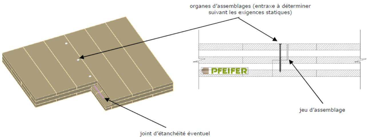
**Figure A.6c – Assemblage « chant contre chant » par vis lardées**
