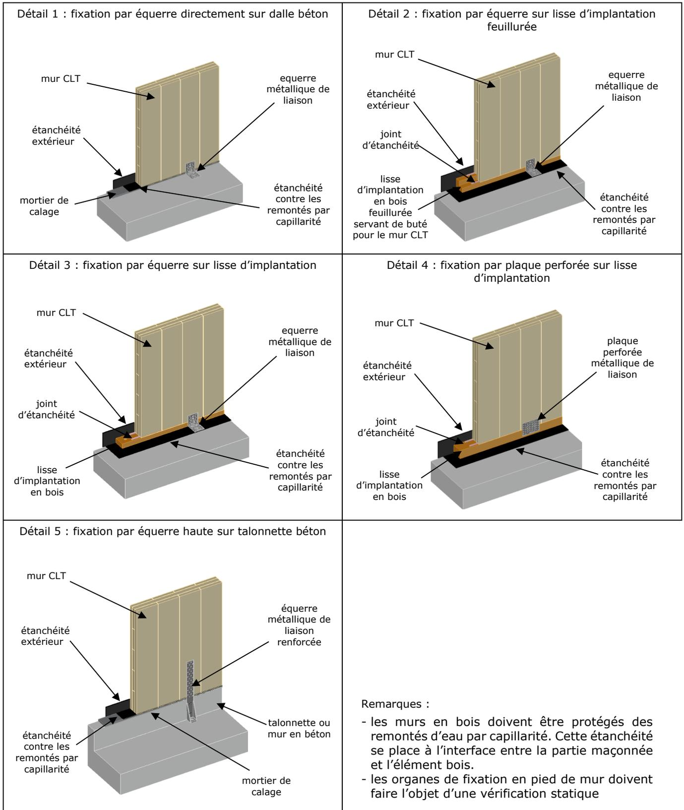
**Figure 13: exemples de liaisons entre panneaux de murs CLT**
