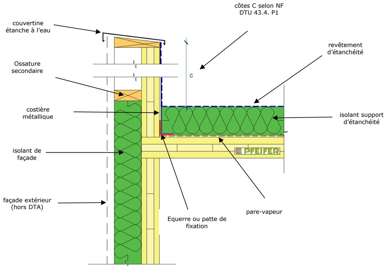
**Figure A.8d – Exemple de relevé en terrasse accessible aux piétons et au séjour**
