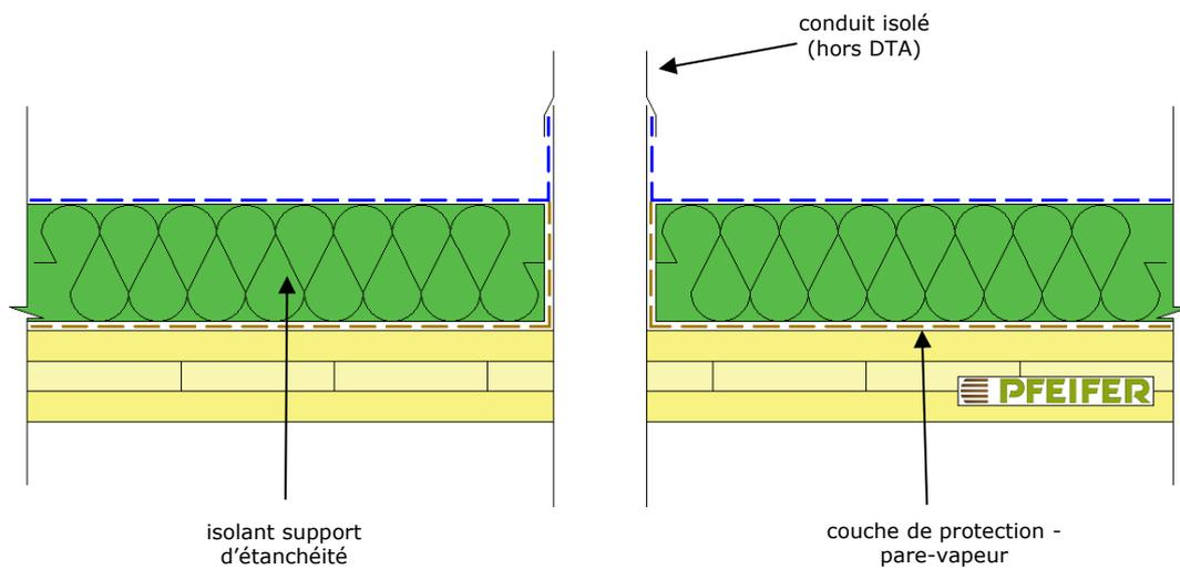
**Figure A.12 – Exemple de jointement sur noue non appuyé – pente  $\geq 1,5\%$**
