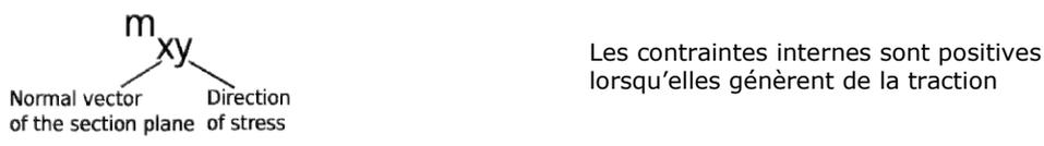
**Figure 6 : contraintes internes bidirectionnelles pour les éléments structuraux conformément à la convention commune des programmes aux éléments finis**
