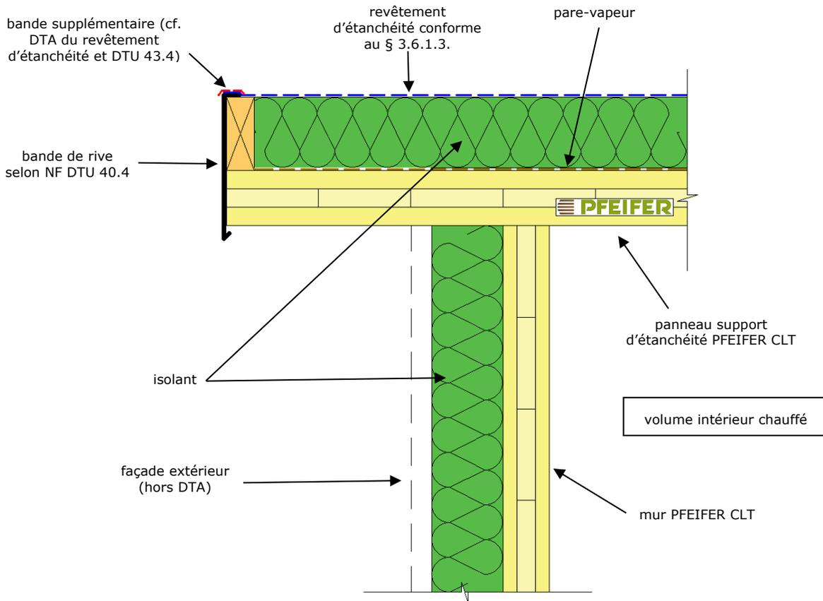
**Figure A.8a – Exemple de relevés sur ossature secondaire avec costière métallique (selon NF DTU 43.4. P1) en toitures inaccessibles, technique ou végétalisée**
