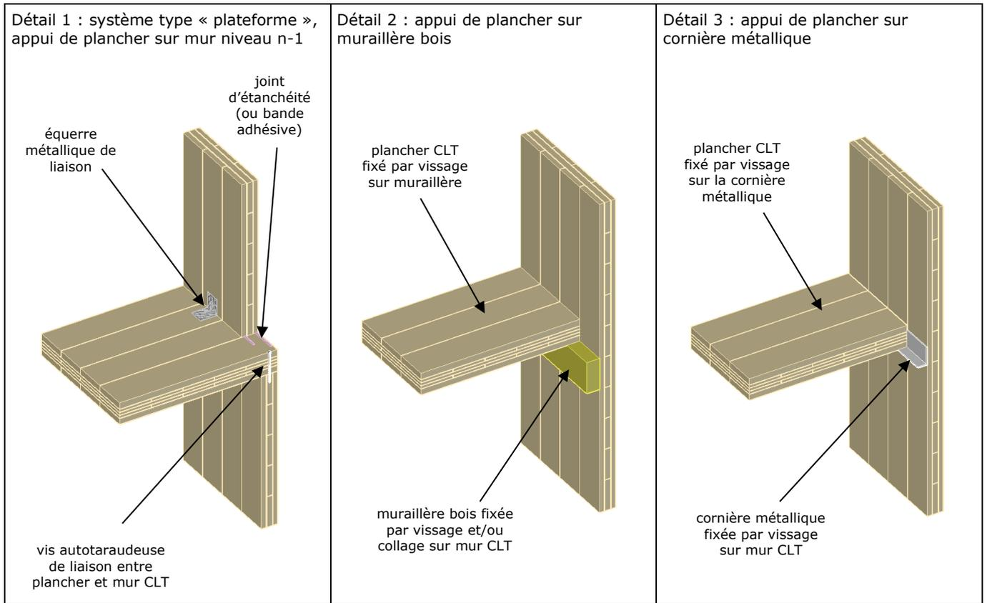
**Figure 17: exemple de liaison entre mur extérieur et plancher intermédiaire (vue en coupe)**
