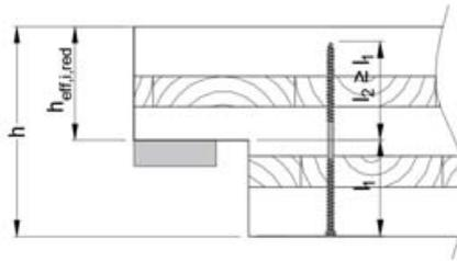
La vérification de la traction transversale se justifie sur une seule rangée de vis. Les pinces à retenir sont celles décrites dans l'ETE du fabricant de vis ou par défaut celles selon la norme NF EN 1995-1-1.
