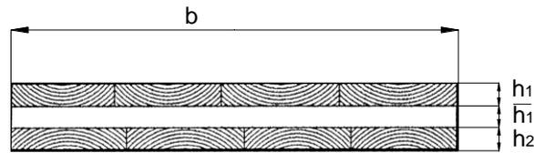
Figure 1 – Coupe transversale d'un panneau 3 plis
