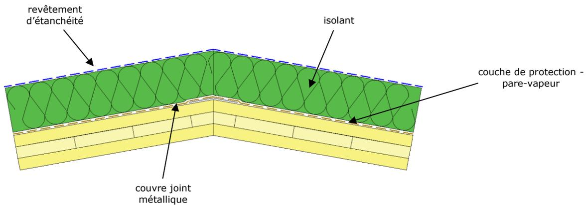
**Figure A.14a – Pose dite « chevron » avec sens de portée des panneaux suivant rampant**
