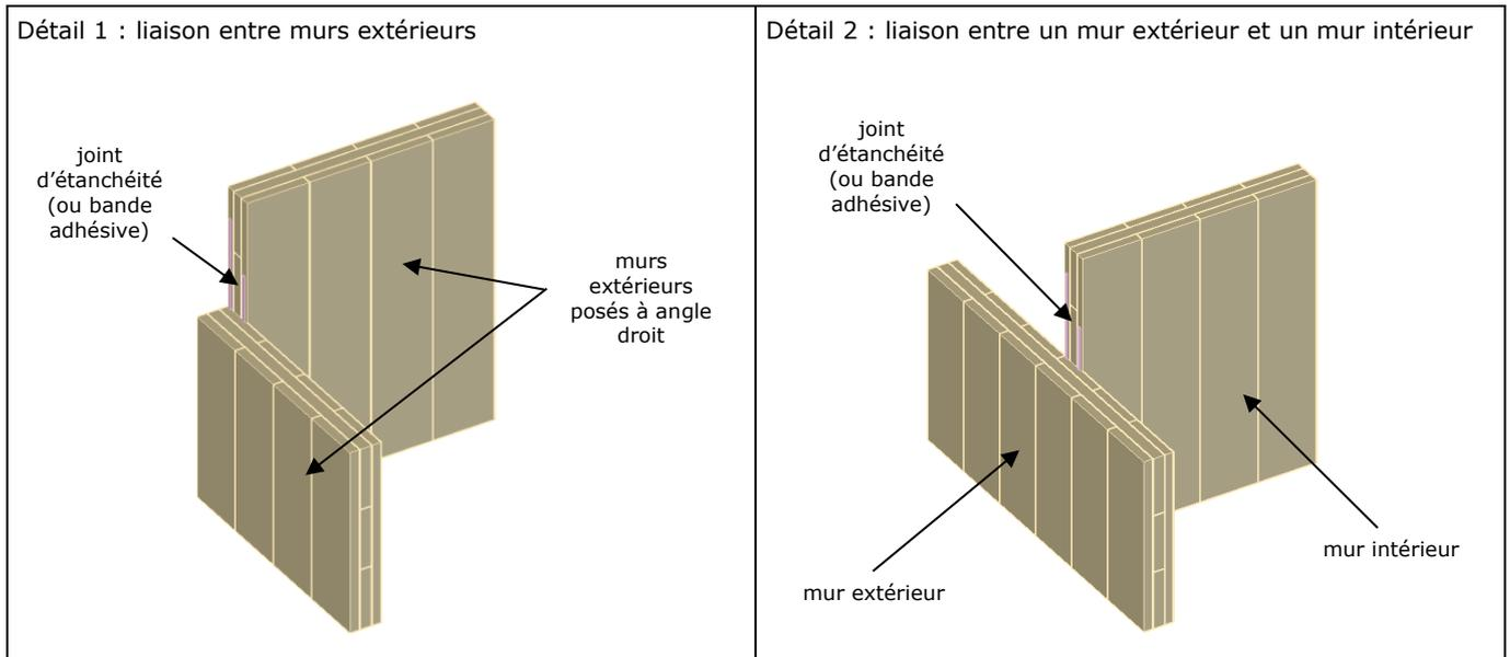
**Figure 14: assemblage de panneaux muraux en angle**
