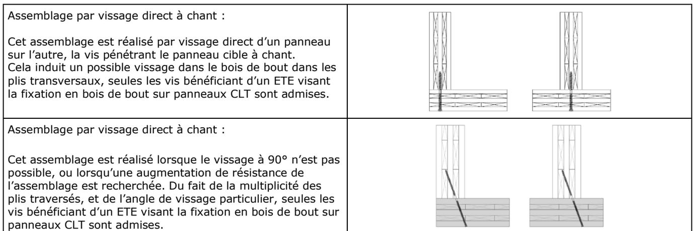
**Figure 15: exemples de liaisons entre un mur extérieur et refend intérieur (vue en plan)**
