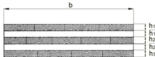
Figure 2 – Coupe transversale d'un panneau 5 plis
