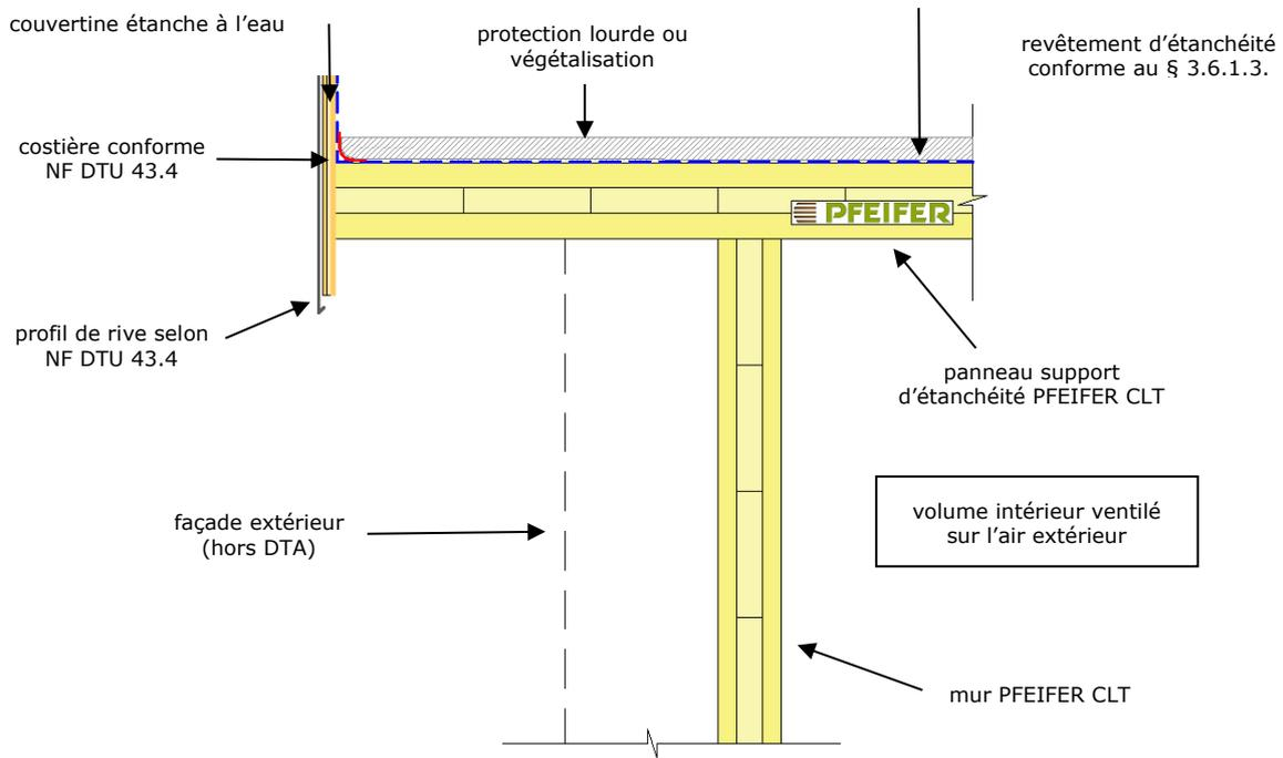
**Figure A.7b – Bande de rive métallique – Bâtiment chauffé avec toiture isolée**
