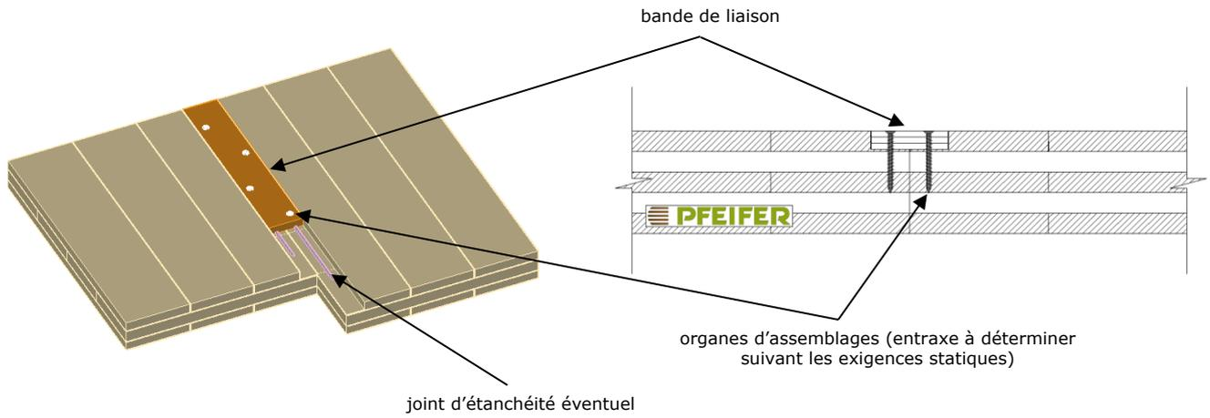
**Figure A.6b – Assemblage à « mi-bois »**
