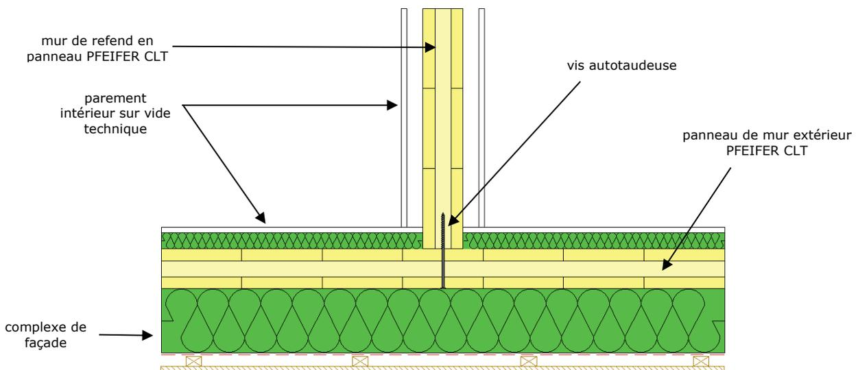
**Figure 16: exemples de liaisons entre panneau de mur et plancher intermédiaire CLT**
