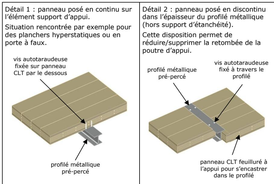
**Figure 22: exemples de reprise d'un appui ponctuel type poutre, sur mur CLT (vérifications suivant §2.8.3.)**
