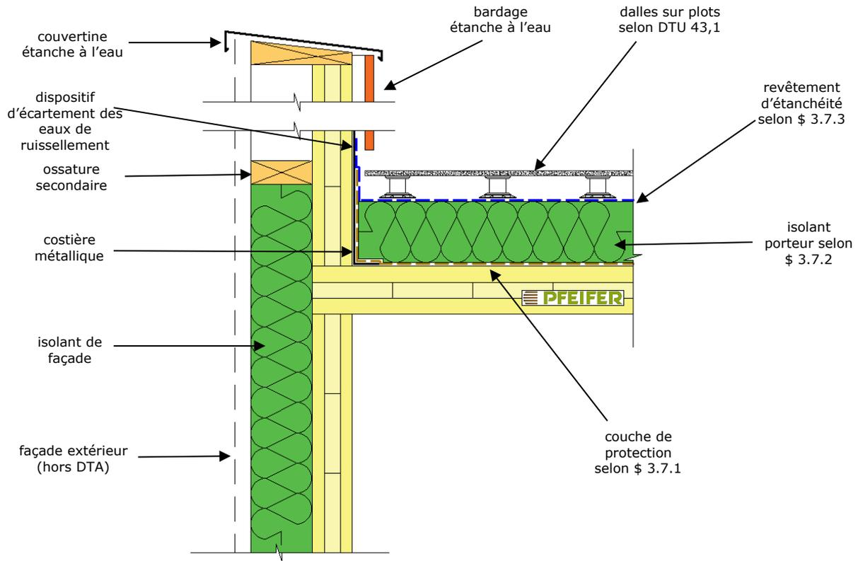
**Figure A.9 – Descente des eaux pluviales en terrasse accessible aux piétons et au séjour**
