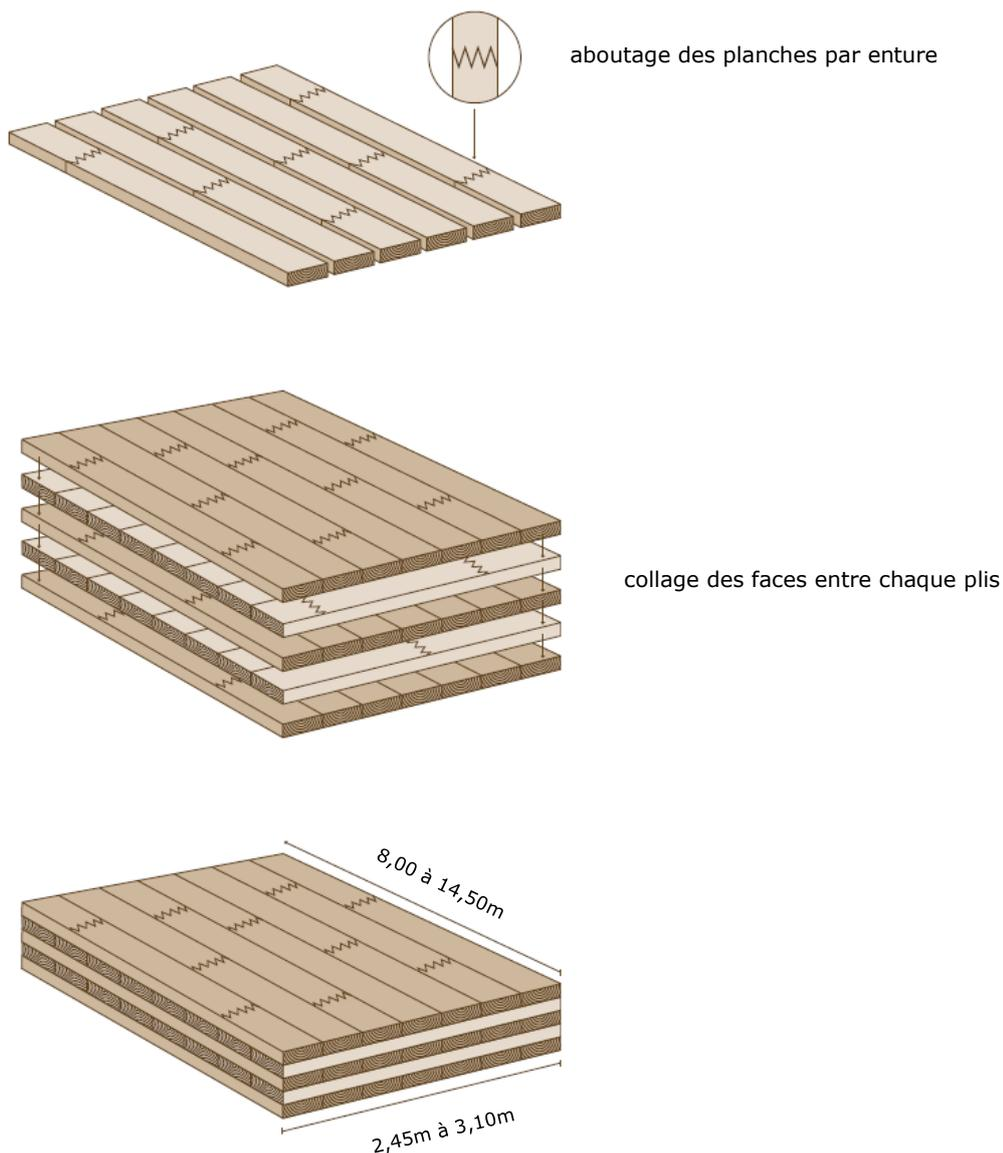
**Figure A.6 – Exemple d'assemblages des panneaux PFEIFER CLT**
