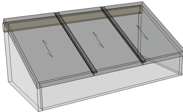
**Figure A.14b – Pose dite « lambourde » avec sens de portée des panneaux parallèle au faitage**
