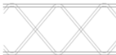
Figure 90 : Géométrie des raidisseurs double sinusöide
