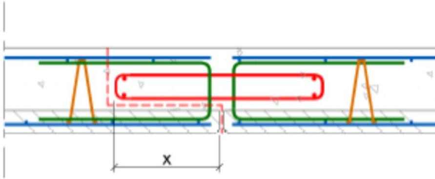
$$V_{Rdi} = \left[ c \cdot \frac{f_{t,n}}{\gamma_c} \cdot 2x + \mu \cdot \left( \sigma_n + \rho \cdot \frac{f_e}{\gamma_s} \right) \cdot 2x \right] \cdot 1$$
