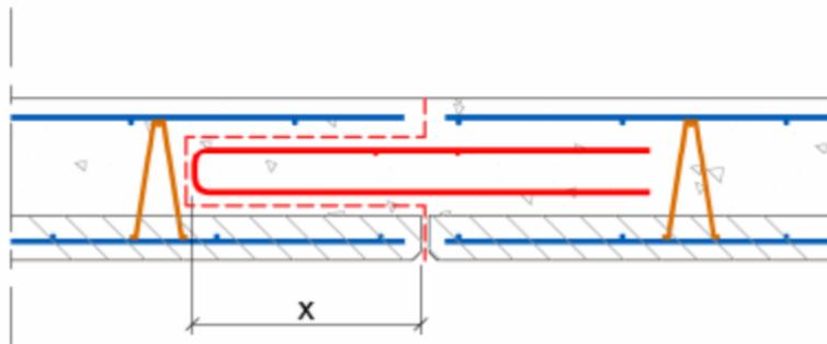
$$V_{Rdi} = \left[ c \cdot \frac{f_{t,n}}{\gamma_c} \cdot 2x + \mu \cdot \sigma_n \cdot 2x \right] \cdot 1$$
