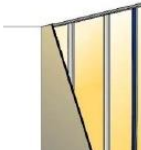
Figure 7 : Contre-cloison constituée de montants simples ou doubles sans fixation intermédiaire au support
