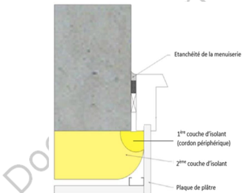
Figure 2 : Menuiserie calfeutrée en tunnel, fixée en tableau
