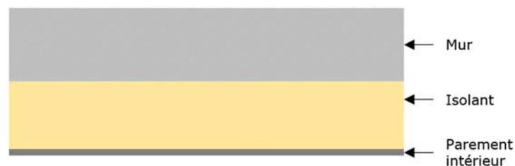
**Figure 11 : Projection sans lame d'air (Cette configuration n'est pas applicable lorsque l'on recherche une performance acoustique)**
