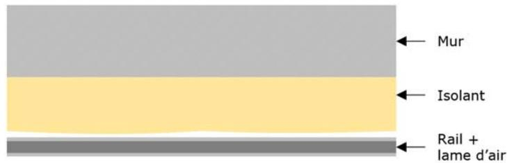
**Figure 9 : Projection avec lame d'air**
