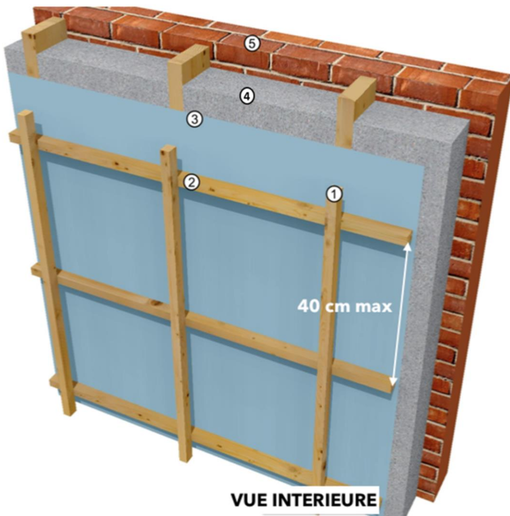
Figure 2A-1 : Insufflation derrière un parement souple, mur maçonné
