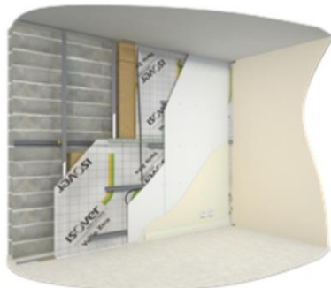
Figure 3-5 : Pose des plaques de plâtre
