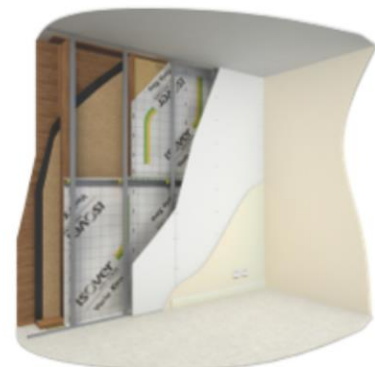
Figure 5-3 bis : Pose de la fourrure intermédiaire et des appuis Optima 2 clipsés. Pose des fourrures métalliques verticales puis celle du parement de finition
