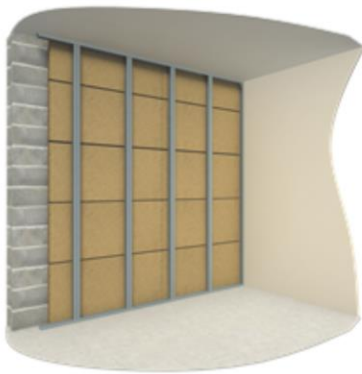
Figure 4-1 : Pose de l'ossature métallique (montants M48 doublés et rails R48) et Insertion des panneaux ISONAT FLEX (40 ou 100mm) derrière l'ossature métallique
