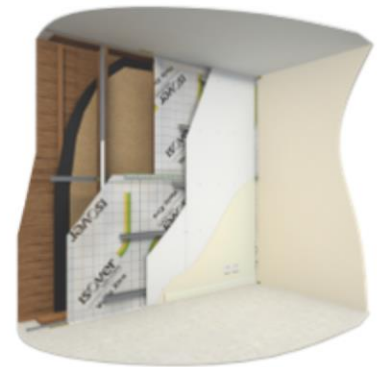
Figure 5-4 : Pose de la membrane Vario® Xtra à l'aide de double face puis installation des Stilmob puis celle de la plaque de plâtre
