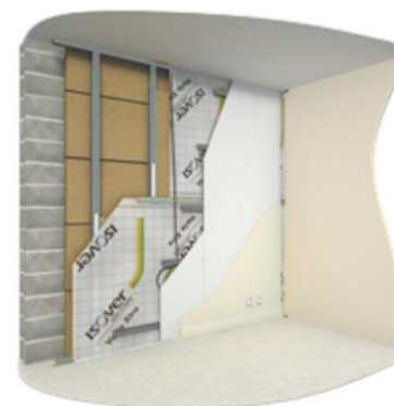
Figure 4-4 : Mise en place des profilés métalliques Stilmob et des gaines électriques (Hors ERP)
