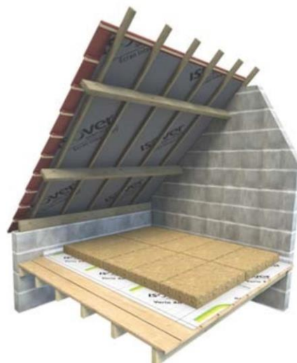
Figure 3.2 : Le produit ISONAT FLEX est posé sur le plancher bois
