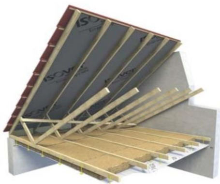
Figure 2.3 : Pose de la membrane pare-vapeur
