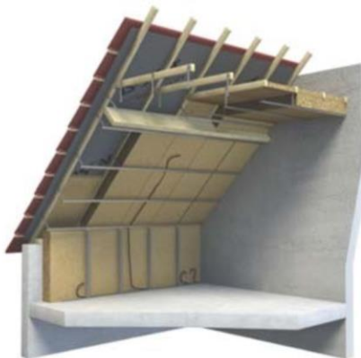
Figure 1.3 : Pose des ossatures métalliques et insertion de la deuxième couche d'isolant en rampant et sur le pied-droit
