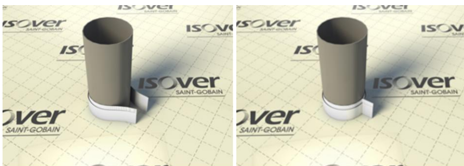
Figure 40 : pose du Multitape autour du conduit pour assurer l'étanchéité à la vapeur d'eau entre la membrane et le conduit
