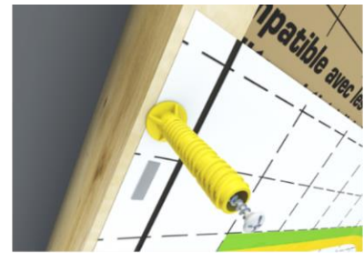
Visser les tiges sous les fermettes
