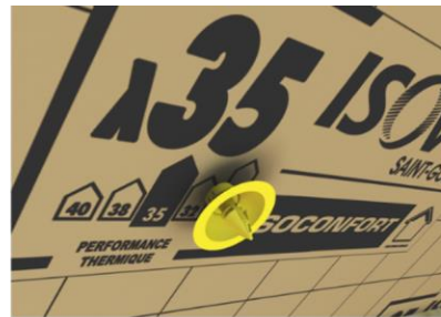
Embrocher l'isolant et clipser la rondelle
