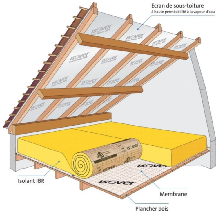
Figure 25 - Pose sur plancher de comble perdu : mise en œuvre d'isolant en rouleau sur plancher de comble perdu
