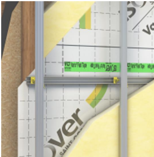
Figure 18 - Pose de la membrane agrafée sur montants bois, entre les deux couches d'isolant, avec doublage en appuis OPTIMA 2 clipé sur une fourrure intermédiaire ou vissés dans l'ossature bois
