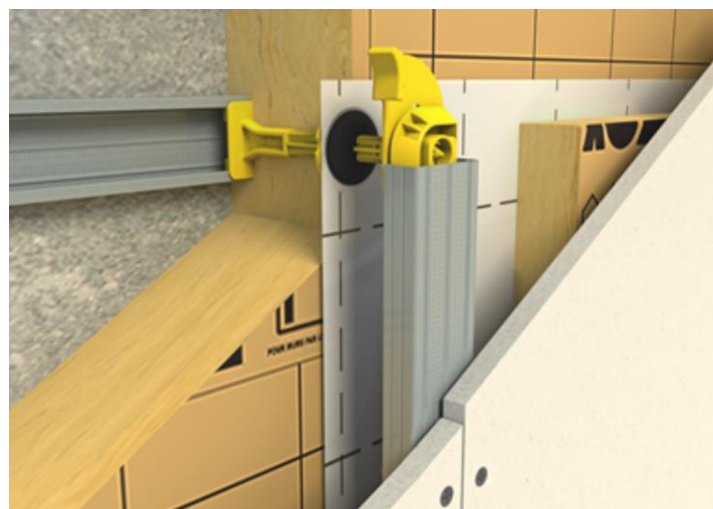
Figure 11 – Variante de mise en œuvre de la membrane entre deux couches d'isolant en mur maçonné avec la pastille OPTIMA 2
