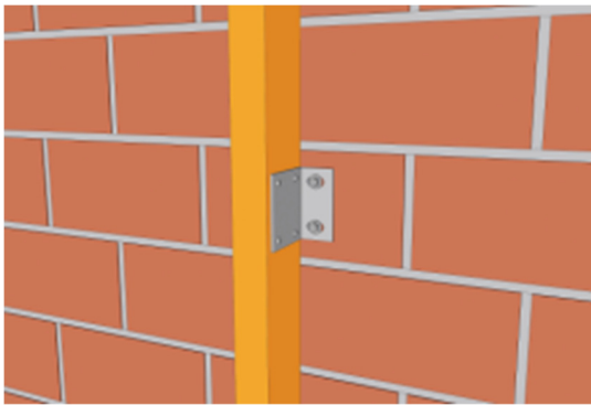
Montage de l'ossature primaire
