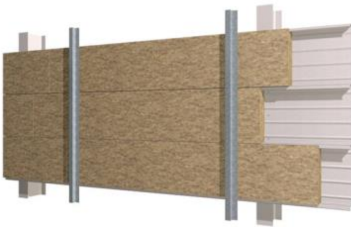
Fixation des ossatures secondaires (Zed ou Oméga°)
