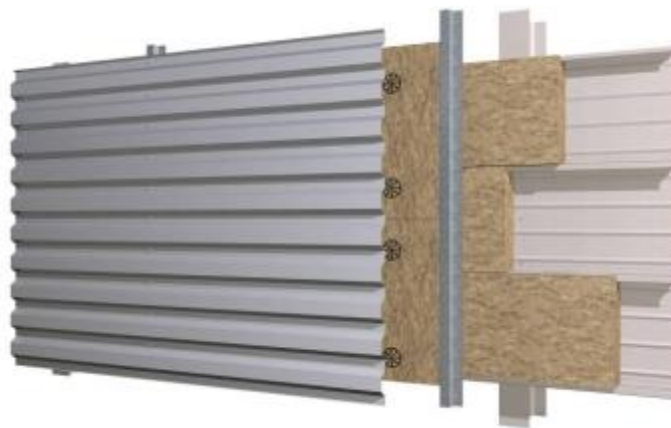
Fixation de la peau extérieure sur les ossatures
