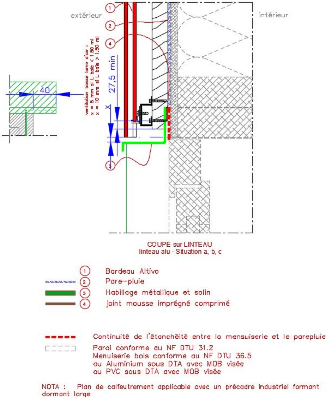
**Figure 39 – Pose à joints fermés sur COB – Coupe sur appui de baie**
