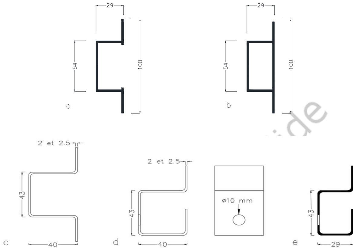
Profils aluminium a, b, c :  $EI = 353070 \times 10^4 \text{ N.mm}^2$
