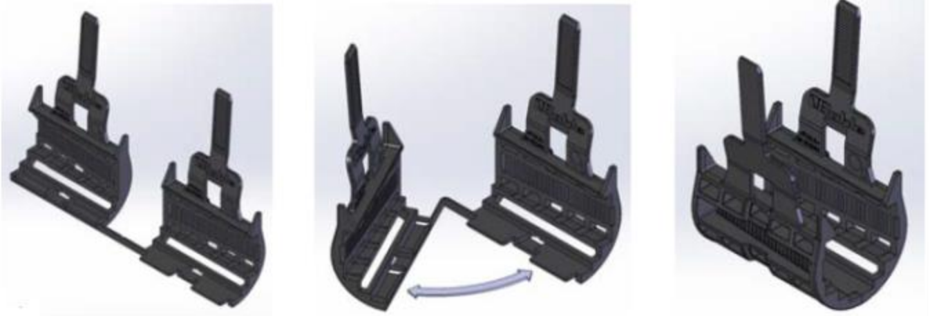
Figure 31.1 – Montage du système de calage Bohle VetroMount
