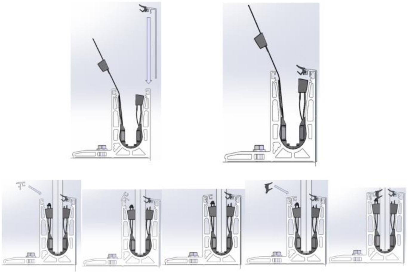
Figure 33.1 – Montage des profils de finition du système garde-corps Bohle VetroMount
