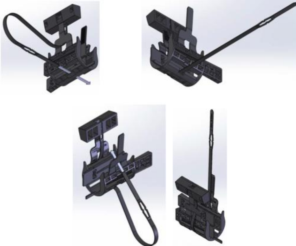
Figure 31.5 – Montage du système de calage Bohle Vetromount
