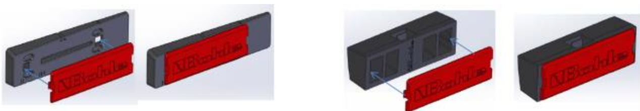
Figure 31.7 – Montage du système de calage Bohle Vetromount
