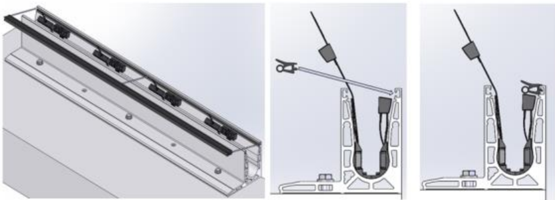
Figure 32.3 – Montage du système garde-corps Bohle Vetromount
