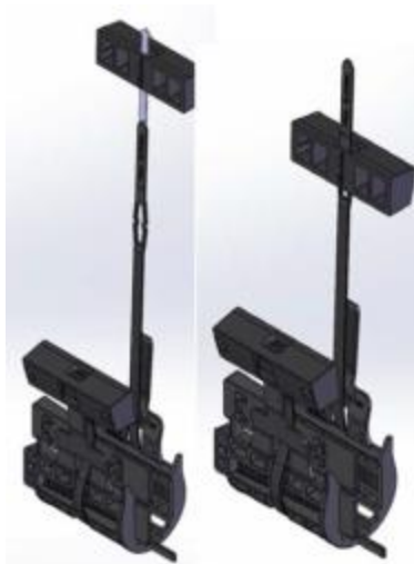
Figure 31.6 – Montage du système de calage Bohle Vetromount
