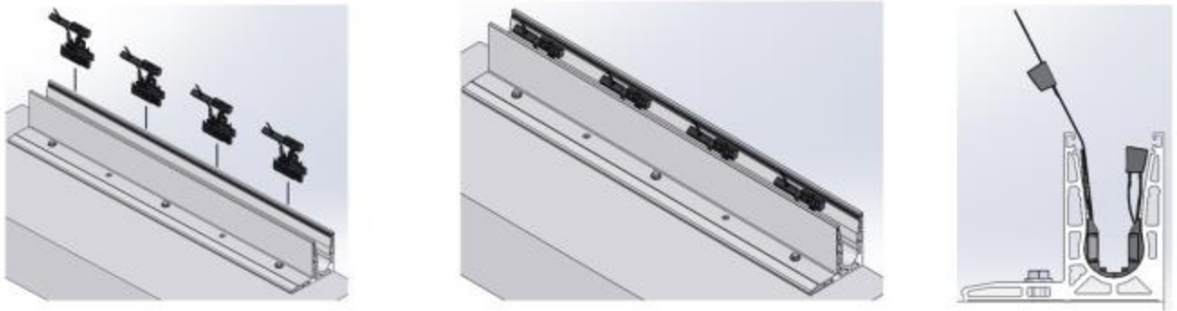
Figure 32.2 – Montage du système garde-corps Bohle Vetromount F
