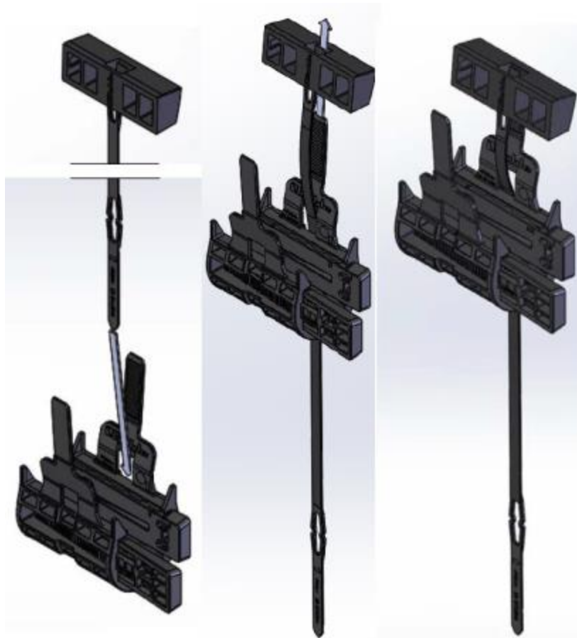
Figure 31.4 – Montage du système de calage Bohle VetroMount
