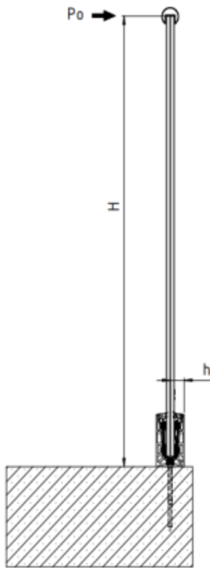
Figure 1 - Schéma pour la pose sur dalle Vetromount U Top
