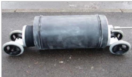
**Figure 5 : Chariot de positionnement avec une manchette**
