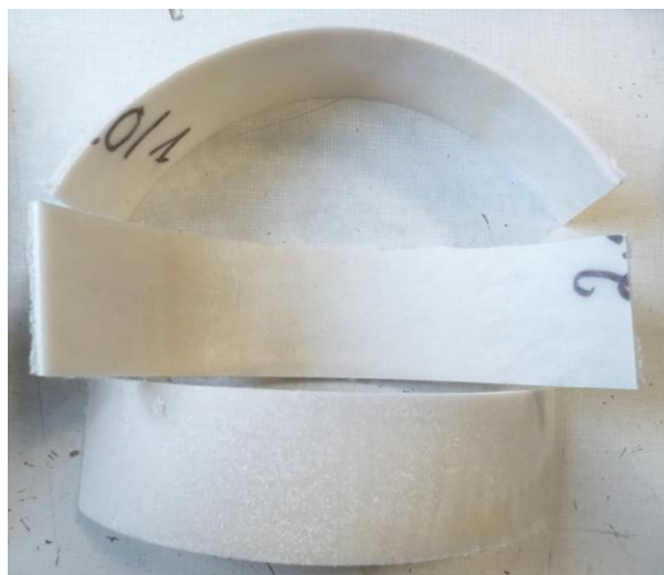
Figure 5 – Photo d'aspect du chemisage polymérisé BREIZH LINER
