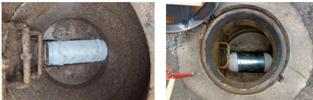
Figure 4 : Modèles de contre-moule pouvant être utilisés pour récupérer un échantillon en regard intermédiaire, au diamètre de la canalisation
