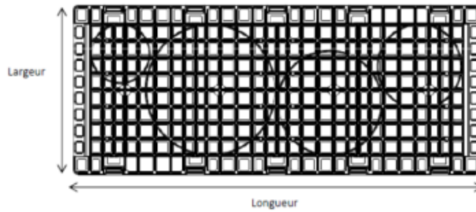
Figure 2c – Façade frontale et latérale RAUSIKKO® Box C
