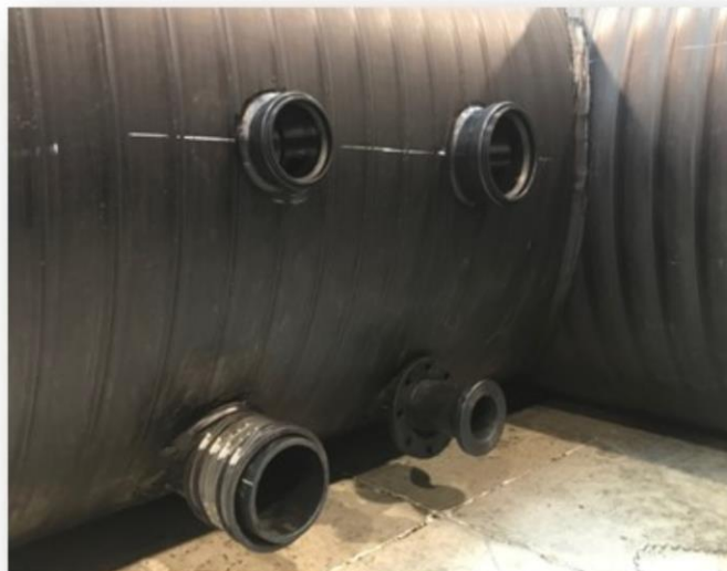
Figure 7 – matérialisation de l'axe vertical et de l'axe horizontal apposés sur les fonds
