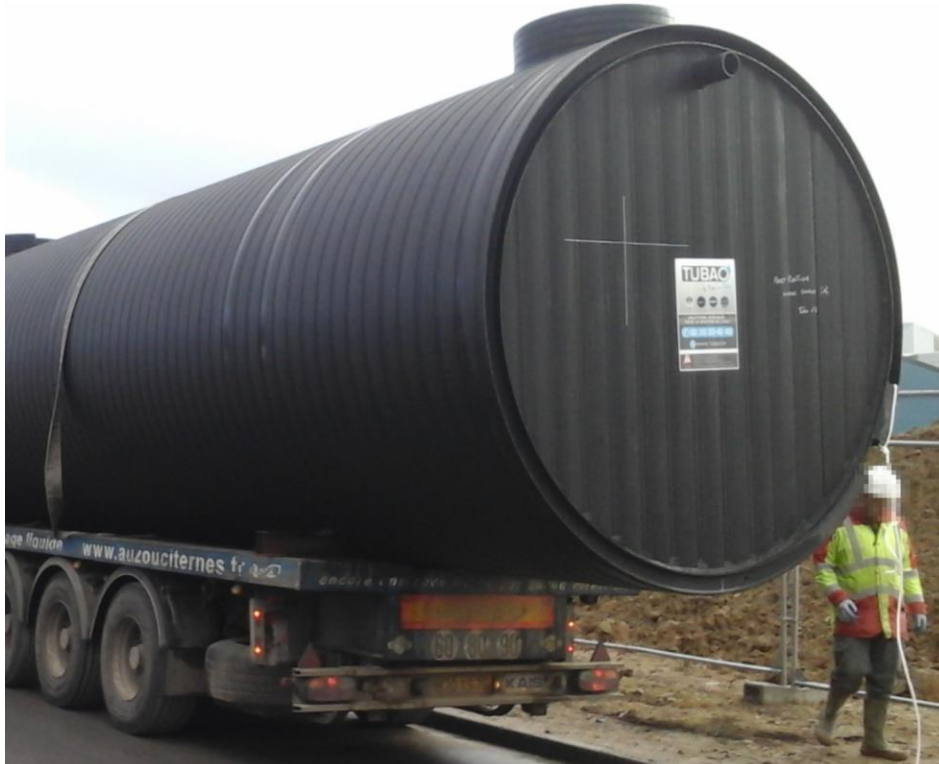
Figure 7 – matérialisation de l'axe vertical et de l'axe horizontal apposés sur les fonds
