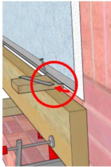
Figure 33 - Découpe du rail (partie support d'enduit) – vue extérieure
