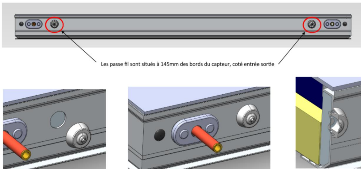
Figure 28 – Passe-fil pour sonde de température
