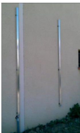
Figure 23 – Exemple de montage mural pour 2 capteurs horizontaux
