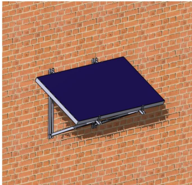
Figure 24 – Exemple de mise en œuvre sur paroi verticale avec châssis CHF à 45°
