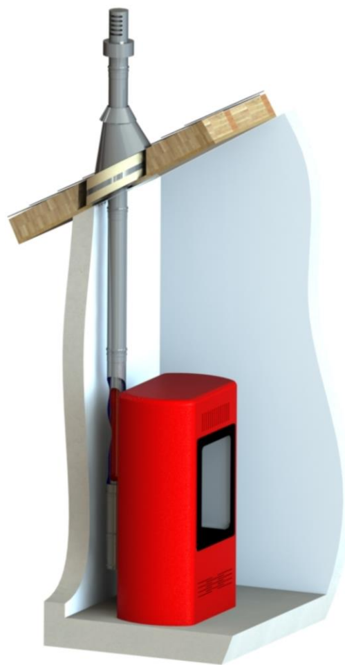
Figure 5.1b – Traversée de rampant Système d'isolation DINAKISOL
