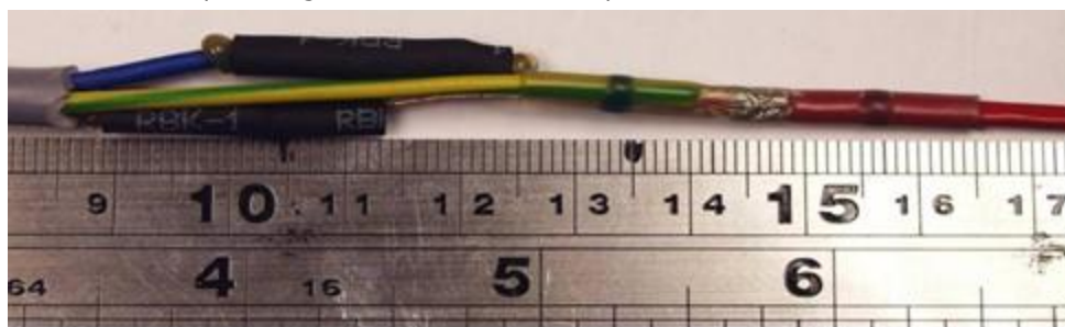
Figure 5 – Réalisation de la jonction froide en usine
