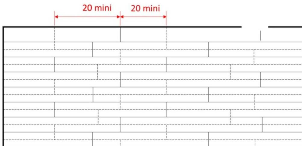
**Figure 4 - Illustration 2<sup>ème</sup> lit de plaques Placosol® (cotes en cm)**
