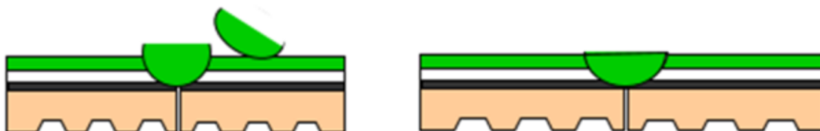
Figure 8 - Arasement du cordon de soudure
