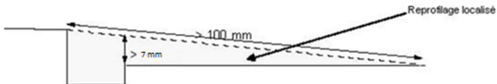
d) discontinuité de niveau + dépose d'une cloison
