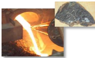
Procédé de vitrification par torche plasma (Inertam)
