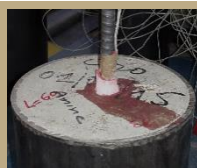
Rupture à l'interface résine/béton (130°C)
