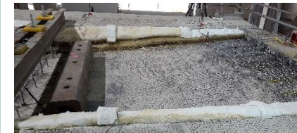
Chute de la dalle à l'intérieur du four à la fin de l'essai
