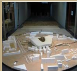
Figure 1 : Stade Vélodrome de Marseille - maquette en soufflerie au CSTB et photo du stade
