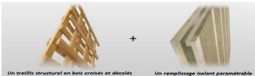
Concept du système pour obtenir CLT innovants (www.techniwod.fr)
