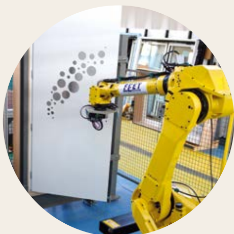
Essais d'ouverture fermeture du bloc-porte
