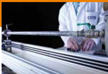
Essai de flexion sur RTS DN 20
