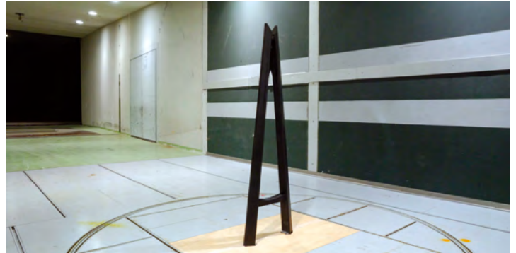
> Essai à la tenue au vent dans la soufflerie Jules Verne.
