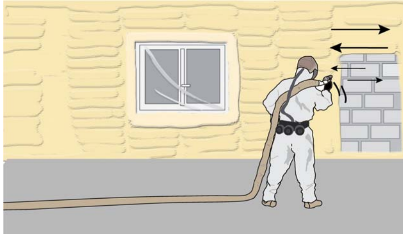
Figure 10 : Réalisation de la projection
