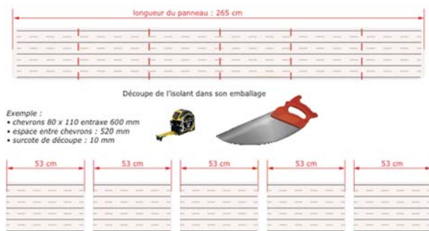
Figure 5 Découpe de l'isolant dans le sens de la longueur, dans son emballage (surcote : + 1 cm)
