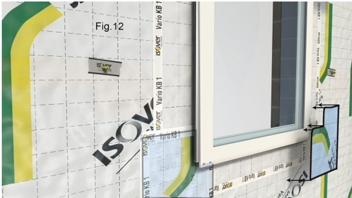
Figure 12 - Réalisation de la pose de la membrane périphérie des menuiseries et étanchéité aux angles par mouchoirs rapportés
