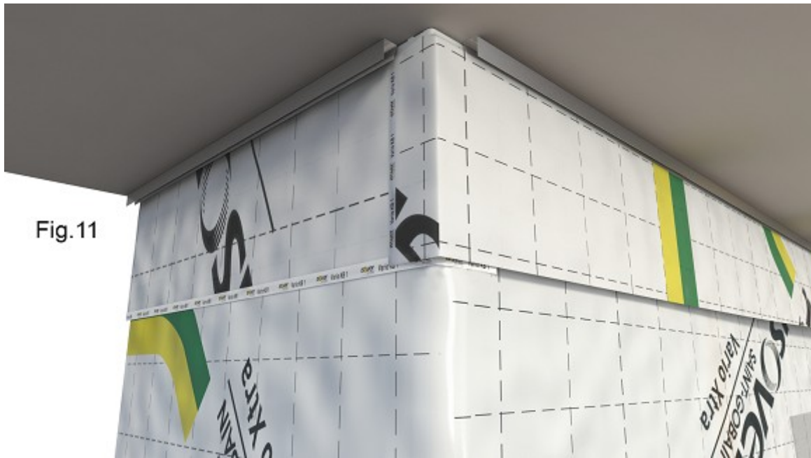
Figure 11 : détail raccordement la bande de départ de la membrane sur la membrane de la paroi
