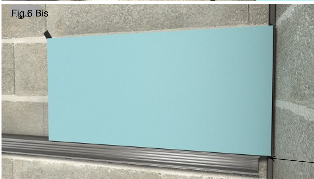
Figures 6 et 6 bis - Détail pose d panneau sur lisse intermédiaire sur bandes résilientes
