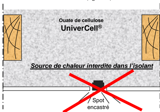
Figure 2 : Spot encastré non protégé interdit dans l'isolation
