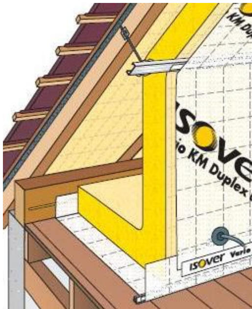
Figure 46 – Réalisation de l'isolation et de l'étanchéité à l'air du pied droit avant mise en place de l'espace technique et du parement intérieur
