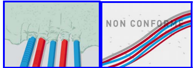
Les conduits doivent être séparés
