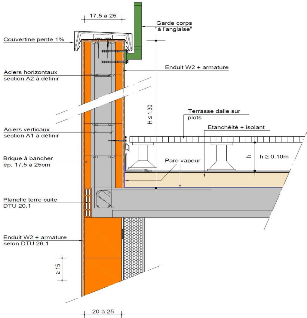
Figure 7 : Coupe avec garde-corps métallique (1)
