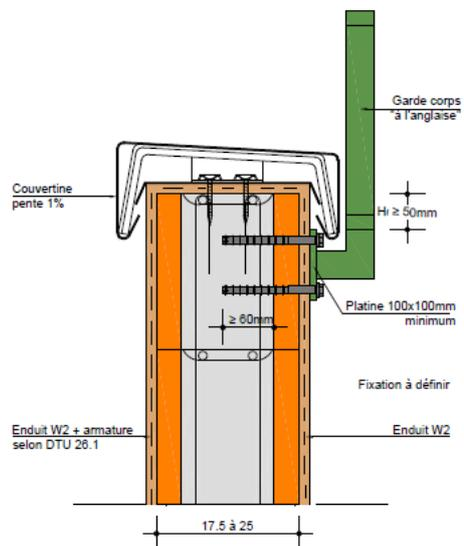
Figure 8 : Coupe avec garde-corps métallique (2)
