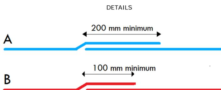
*Recouvrement minimum entre les lès – Termiprotect Film et Périfilm (A) et Périfilm AD (B)*
