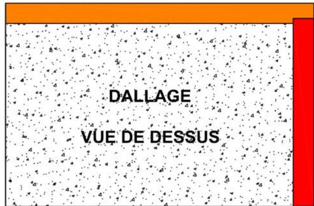
ETAPE 2 : On déroule le 2ème lé de Kordon sur le bord du dallage avec une recouvrement du 1er lé de 5cm minimum
