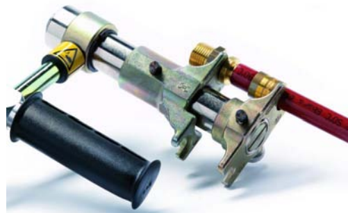
Figure 2 - Placement des mors à sertir
