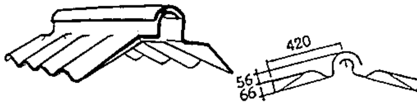
Figure 6 – faîtière de ventilation à charnière
