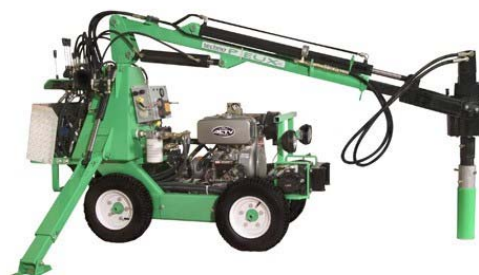
Figure 4 – Machines pour l'installation des TECHNO PIEUX®
